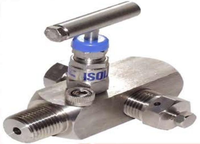
Valvula gauge para alta presion, con tapon y valvula de purga con venteo atmosferico, con un largo de 95 mm. Teminales: macho NPT a hembra NPT para una presion de operacion de: 10,000 psi a 70 °F fabricada en acero inoxidable tipo 316 , con puertos de purga de NPT hembra, bonete con punta de vastago rotatoria de acero inoxidable 17-4ph con empaquetadura inferior de rtfte que protege el vastago del flujo, fabricada en cumplimiento de la norma nace MR -01-75.
